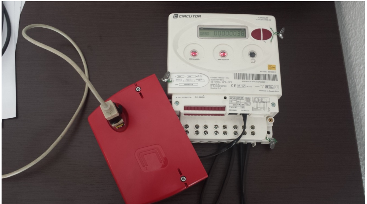
Figura 14. Nuestro contador de energía conectado a pc con convertidor RS232 y al PC.
