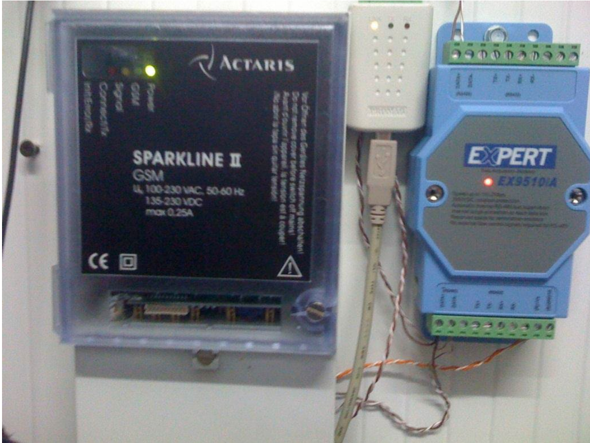
Figura 3. Modem GSM con convertidor RS232 para lecturas remotas y convertidor USB para lecturas con ordenador local.
